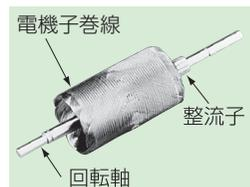
電機子巻線には、図3に示すカップ形のほかに、円板状のディスク形がある。ディスク形の一例としては、図4に示すプリント配線モーターがある。
